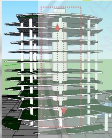
Pada High Rise Building, transportasi sirkulasi vertikal dengan melalui lift yang diletakkan pada core.
