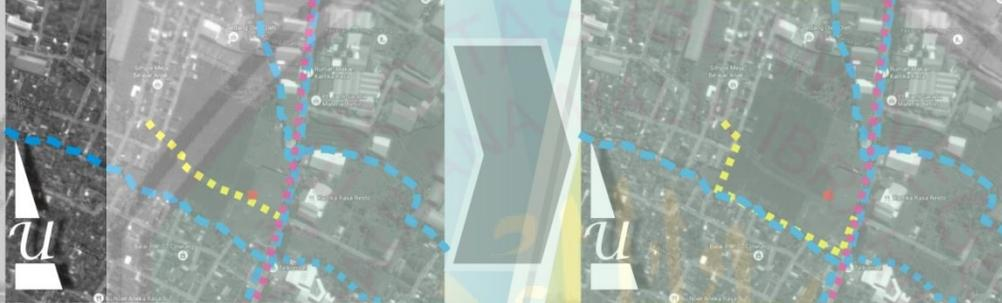
Perubahan jalur aliran pembuangan air dari lingkungan warga yang melintasi tapak (garis putus kuning). Perubahan dimulai sebelum jalur aliran memasuki tapak dan dialirkan ke sungai di selatan tapak. Perubahan karena aliran air dari lingkungan ini berasal dari limbah dapur perumahan yang beraroma tidak sedap, banyak sampah, dan berwarna buruk.
