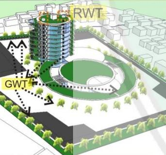
Sistem pemakaian air : Air yang telah dipakai pada building akan tidak langsung dibuang namun disimpan di GWT lain untuk digunakan sebagai sumber mengairi lanskap.
