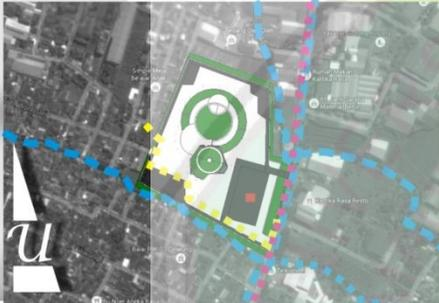
Pada jalur aliran air, membiarkan aliran air dari warga mengalir ke tapak namun dengan penyesuaian yakni dengan tetap mempertahankan jalurnya melintasi tapak namun sedikit dirubah menyesuaikan jalur drainase rancangan
