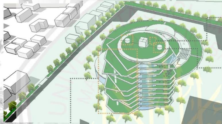
Flat roof beton kemiringan 4 derajat untuk mencegah genangan, erosi atap, dan menangkap udara yang lebih baik dan rea tanam yang lebih luas.
