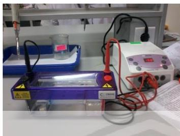
Secara umum, elektroforesis digunakan untuk memisahkan, mengidentifikasi, dan memurnikan fragmen DNA. Prinsip kerja elektroforesis ini adalah memisahkan campuran bahan dengan muatan listrik yang berbeda-beda
