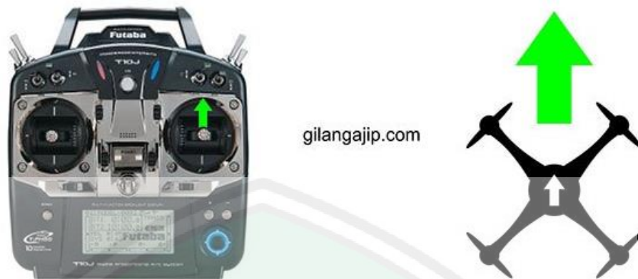
Gambar 2.7. Fungsi Pitch Elevator untuk maju ke depan.
