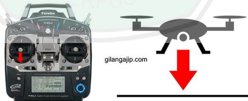
Gambar 2.4. Fungsi throttle untuk turun ke bawah.
