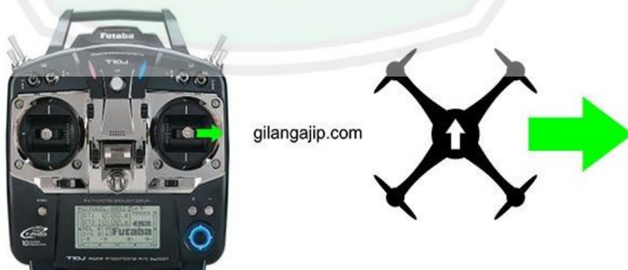
Gambar 2.9. Fungsi Roll ke arah samping kanan.
