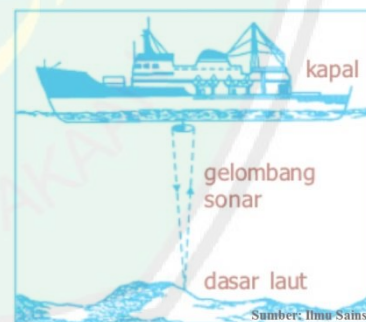
Gambar 11. Pengukuran kedalaman laut menggunakan sonar
