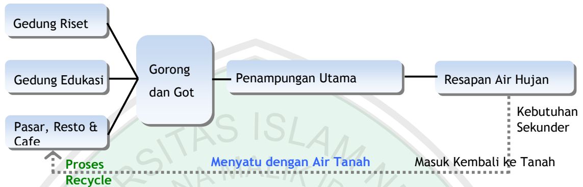
Gambar 4.44 Diagram Analisis Sistem Pengendalian Air Hujan (Sumber: Diktat Kuliah Utilitas, 2009)
