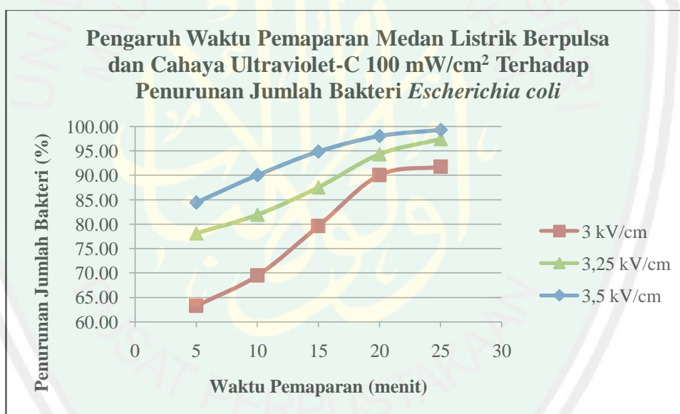
Gambar 6. Penurunan Jumlah Bakteri Escherichia coli setelah Dipapari Medan Listrik Berpulsa dan Cahaya Ultraviolet-C dengan Variasi Waktu Pemaparan
