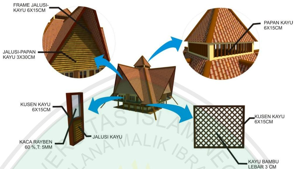
**Gambar 6.21 detail struktur**
