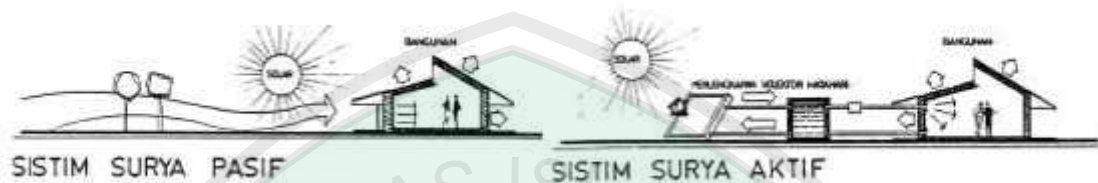
Gambar 2.29. Skema Sistem Surya Aktif dan Sistem Surya Pasif Sumber: Pusat Riset Energi Surya Surabaya, hal, 37
