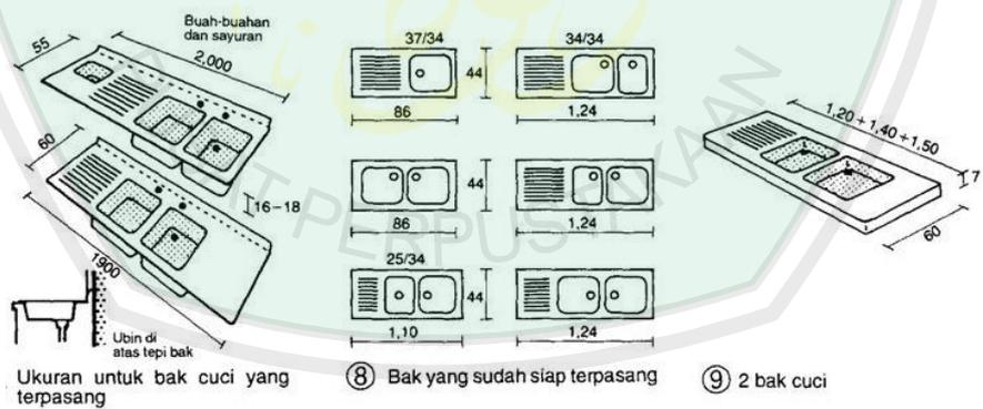
Ukuran untuk bak cuci yang terpasang ⑧ Bak yang sudah siap terpasang ⑨ 2 bak cuci
