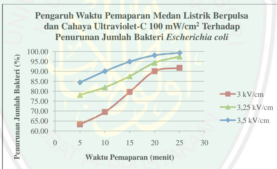
Gambar 6. Penurunan Jumlah Bakteri Escherichia coli setelah Dipapari Medan Listrik Berpuls dan Cahaya Ultraviolet-C dengan Variasi Waktu Pemaparan
