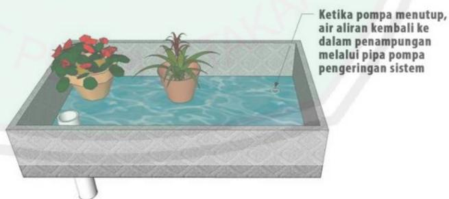
Gambar 2.8 Wadah penampungan air dengan pipa
