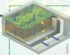
Lapisan pada greenroof. pada lapisan ke 2 terdapat drainage cell, yang berfungsi untuk mengalirkan air hujan pada atap greenrof menuju talang air.
