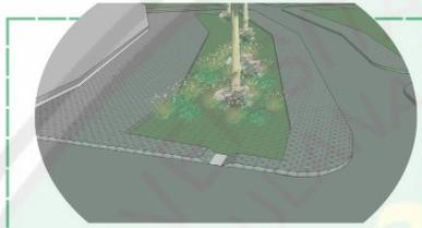
Menggunakan Bump-Out untuk mengalirkan air hujan yang tidak terserap di perkerasan.
