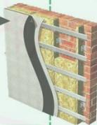
Struktur pada slubung bangunan menggunakan struktur seperti pada bangunan umumnya, dengan penutup selubung berupa batu bata dan memberikan material peredam suara berupa rockwool.
