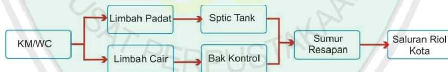
**Gambar 4.56 Sistem Pembuangan Air Kotor Dari KM/WC**
