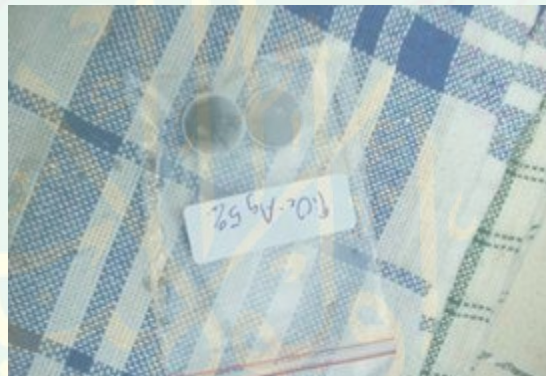
Gambar L.3.2 Hasil pelet TiO 2 -5% Ag
