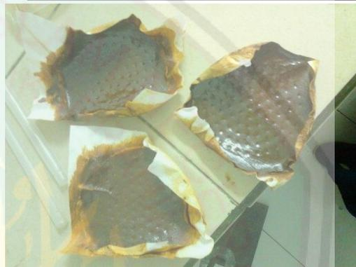
Proses pengeringan hasil sintesis geothit
