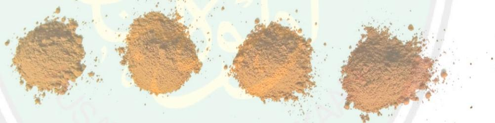
Gambar 4.3 Hasil sintesis pigmen geothit pada suhu 60, 70, 80 dan 90 °C
