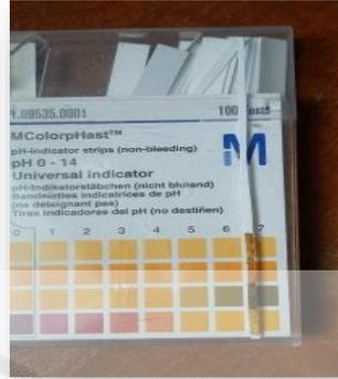
Gambar 8. Pengecekan pH setelah ditambah  $\text{NaHCO}_3$  (pH netral)
