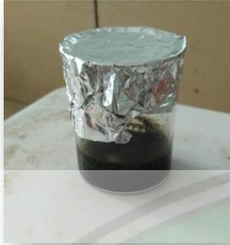
Gambar 7. Hidrolisis dengan HCl 2 N
