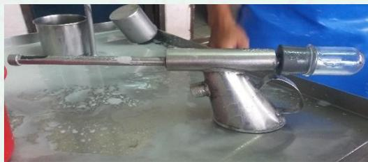
**Gambar 4.1 Solut Tester (alat untuk mengukur kegumpalan)**
