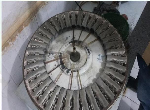
**Gambar 4.6 Sentripus (alat untuk uji lemak)**
