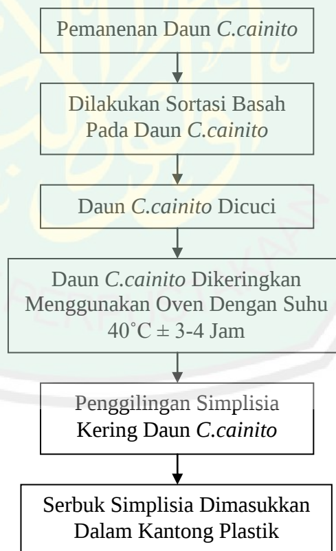
Gambar 2. Skema Preparasi Simplisia Daun C.cainito
